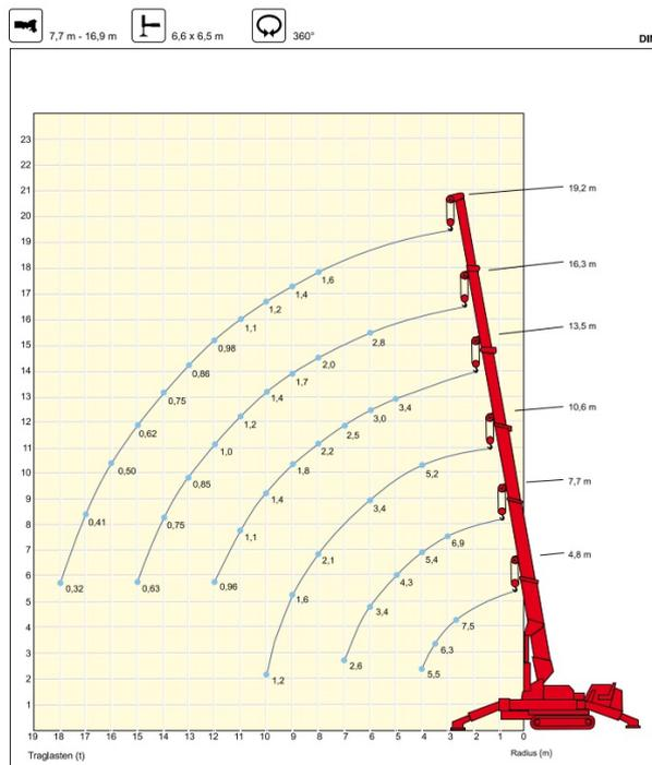
traglasten an der 2,1 m montagespitze - mit wirbelhaken
